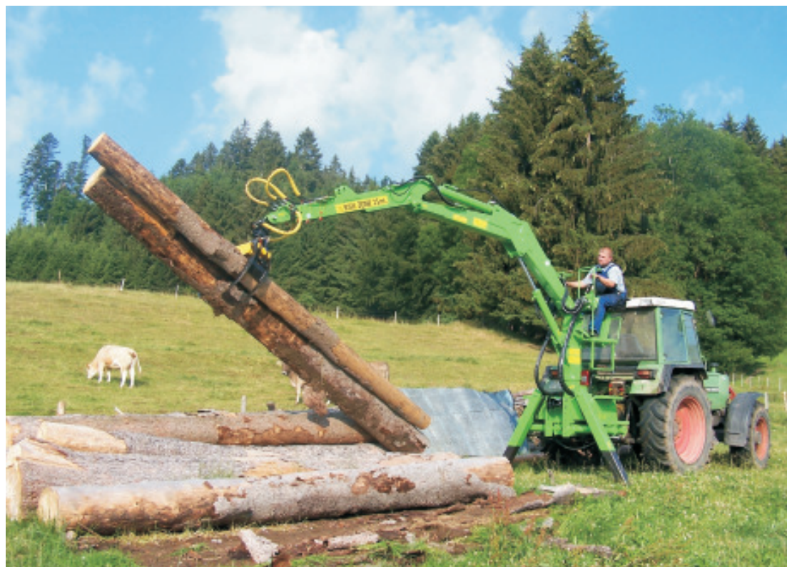
Погрузка на манипуляторе с сиденьем обеспечивает комфорт и быстроту
