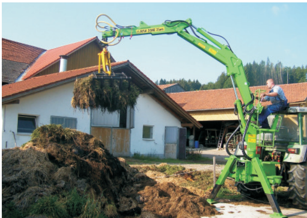
CLN оснащенный вилочным грейфером идеален при погрузке силоса и навоза
