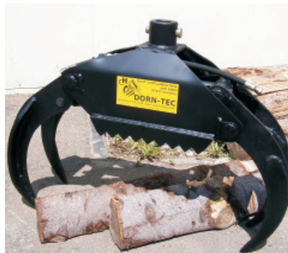
Грейфер 1000R4 с дапол. Зубцами на корпусе
