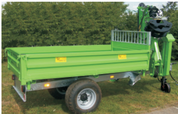
Самосвальный прицеп 3,5 тонны с манипулятором формы -Z
