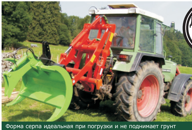
Безопасная погрузка брёвен с гидравлическим зажимом
