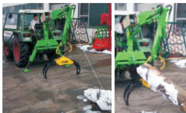
Опорн.ролик обеспечивает идеальную намотку троса
