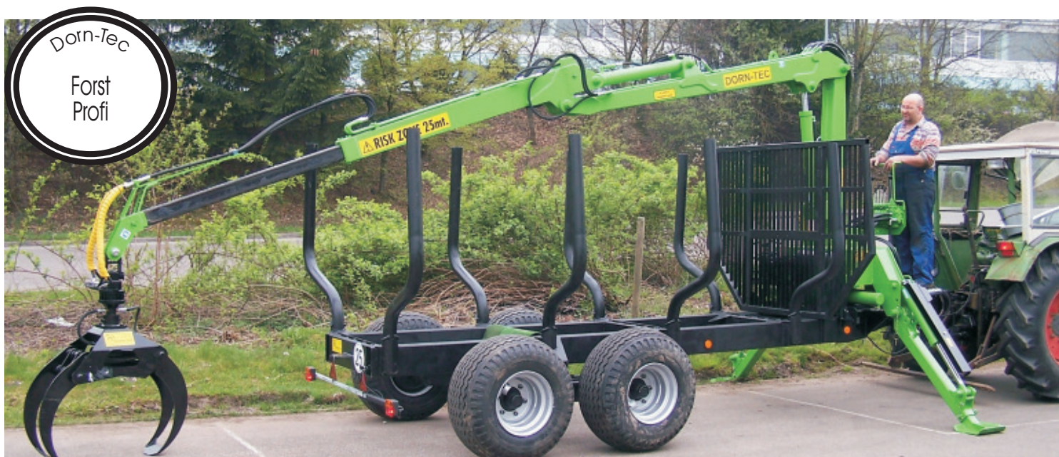
Прицеп Rw100 D с манипулятором с откидными опорными лапами
