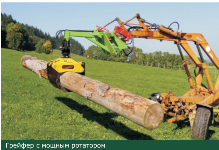
Грейфер с шарнирно механической подвеской
