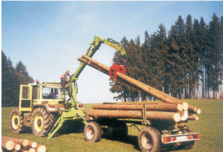
CF- манипулятор с автономной гидравлической системой
