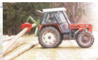
RG 1400 грейфер для штабелирования и трелеровки
