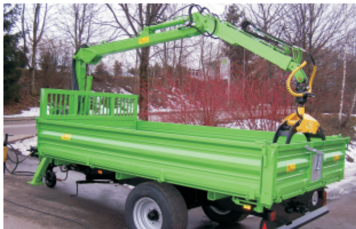
комбинация прицепа и манипулятора для тракторов
