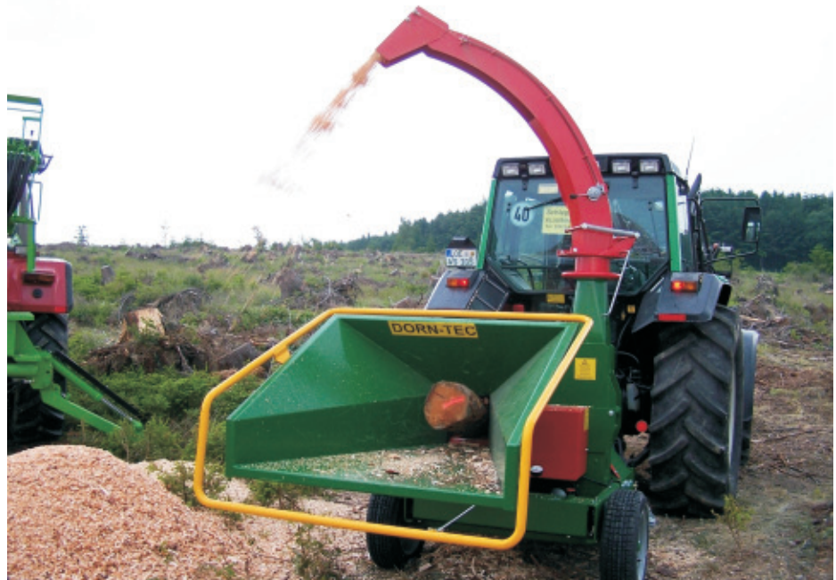
мощные втягивающие вальцы и серийное оснащение NO-Stress (контроль подачи матерьяла)
