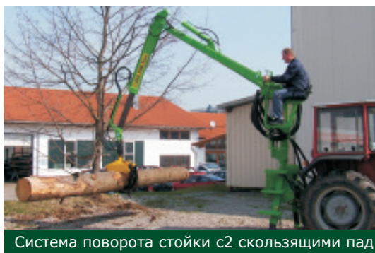
CF- манипулятор с автономной гидравлической системой
