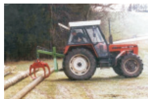
RG 1400 грейфер для штабелирования и трелеровки
